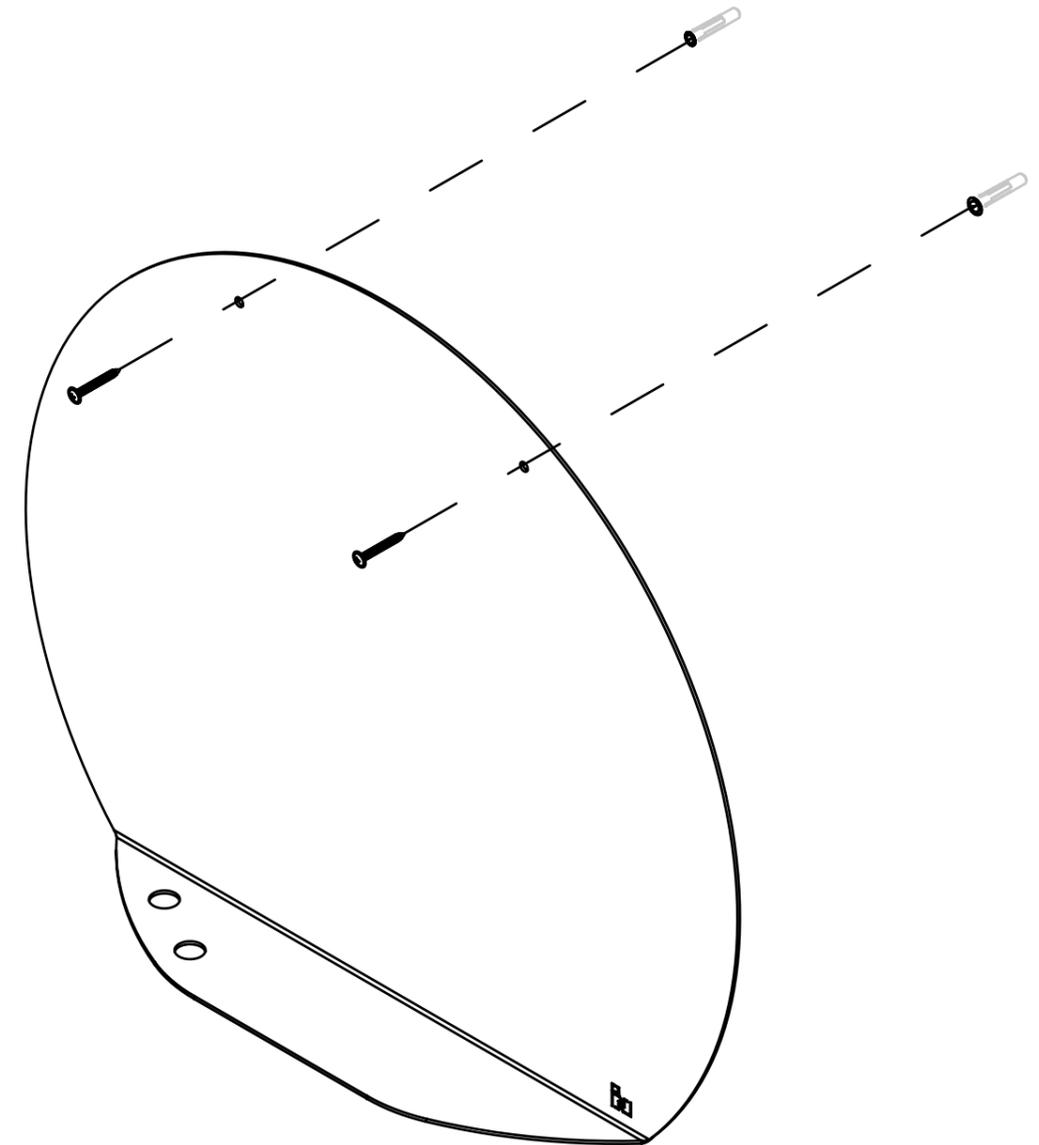
Befestigen Sie die Magnettafel mit den mitgelieferten Schrauben an der Wand.
