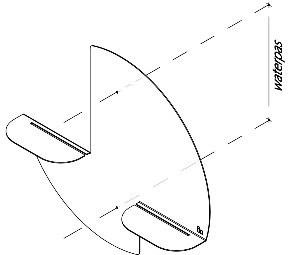
Markieren Sie die Löcher horizontal an der Wand und bohren Sie sie mit einem Ø6-mm-Bohrer vor.
