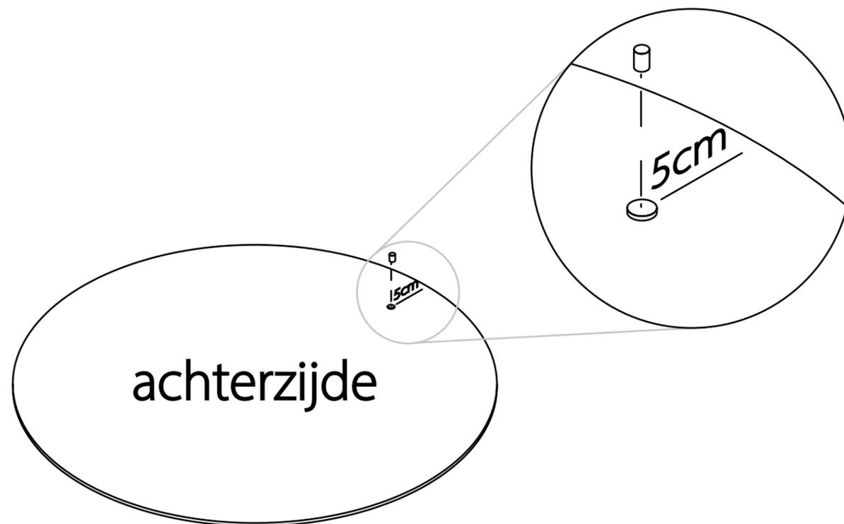
Legen Sie den Spiegel mit der Spiegelseite nach unten auf eine weiche Unterlage und kleben Sie die Magnetplatte etwa 5 cm vom Rand entfernt auf.
